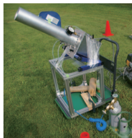
消防車到着前に有効な空圧式消火弾発射砲
