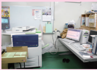
PCデータをそのまま印刷機に取り込み直接印刷するオンデマンド印刷機
