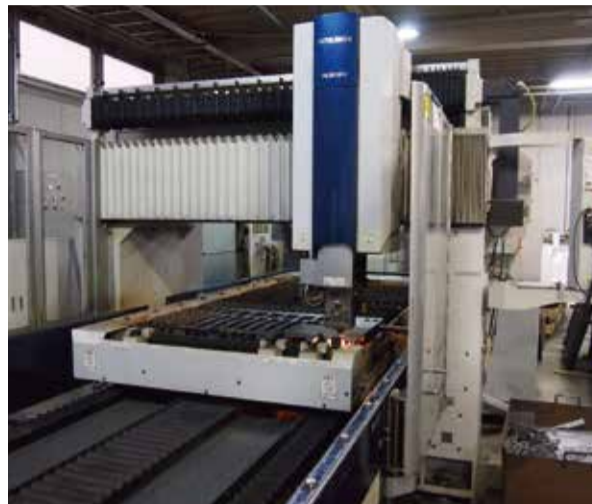
レーザー加工機による鉄の切断と穴あけ加工
