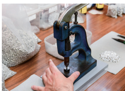
テフロンと真ちゅうを組み込んでテフロン端子を製造
