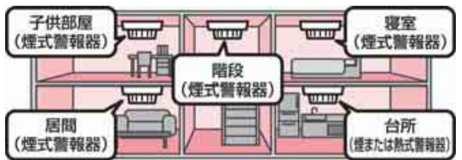
住宅用火災警報器の設置場所
