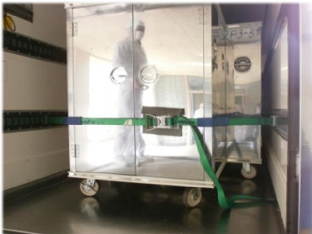
(1) 配送トラック 小学校で調理された給食が到着。トラックでの移動中、コンテナが動かないようにベルトでしっかり固定しています。
