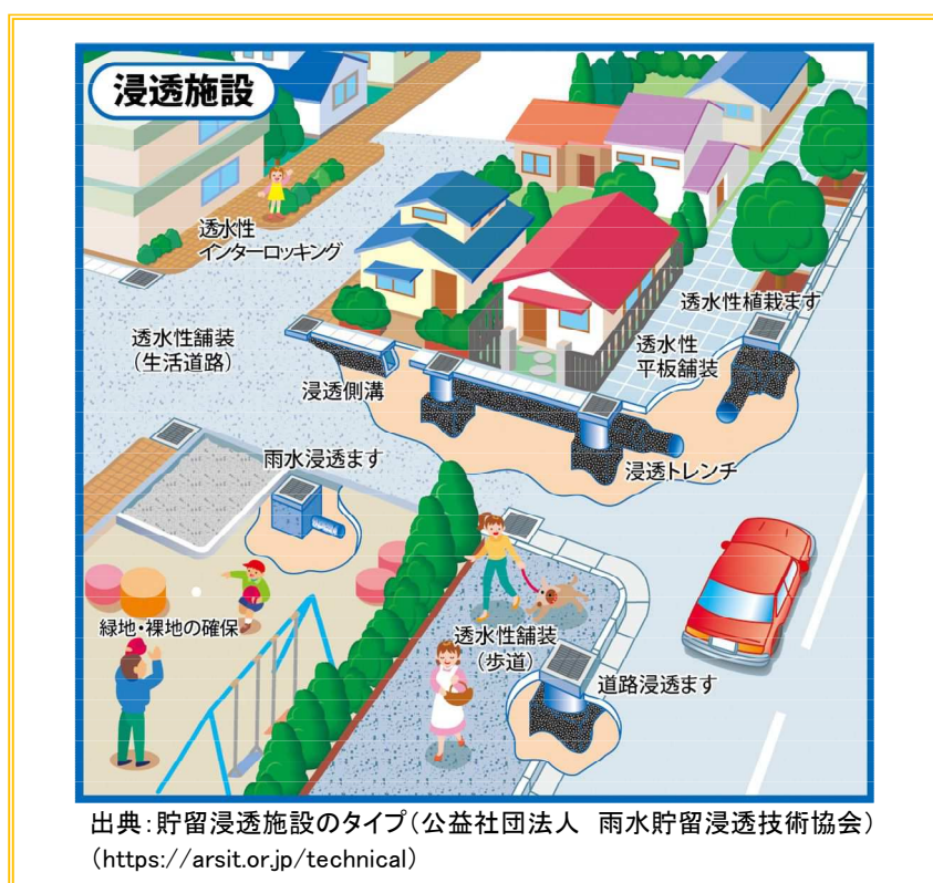
図 4-14 浸透施設のイメージ
